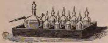
Fig. 54. — Flacons de culture avec leur bouchon à l'émeri terminé par un tube à coton stérilisé.
